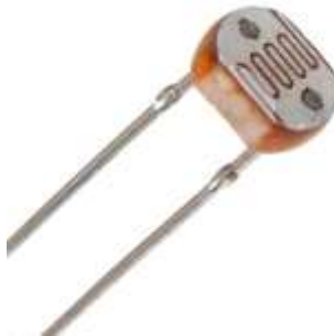
Figura 23. Fotorresistencia usada en el proyecto.
