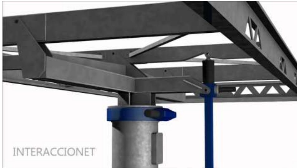
Figura 7. Estructura de seguidor solar.
